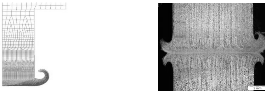
Abbildung 16: ORS: berechnete Verformung (links) und Längsschliff (rechts)
