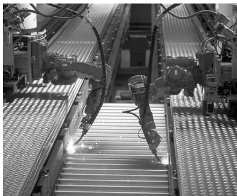
Abbildung 1: Schweißen von Wellstegträgern [Pasternak, 2009]
