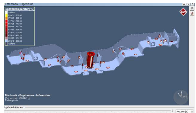
Abbildung 14: Spitzentemperatur nach dem Heften
