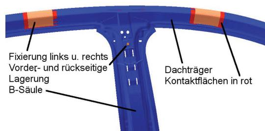
Bild 1: Dachträger-B-Säule in einer Einspannung vor Schweißbeginn
