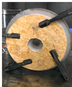
(b) WIG-Handschiweißung einer doppellagigen kreisringförmigen „Die-Less-Hydroforming“-Platine entsprechend Abbildung 2 (a) bei Verwendung einer Spannvorrichtung aus OSB-Platten (Foto: M. Rzepecki, KIT Versuchsanstalt, 2014)
