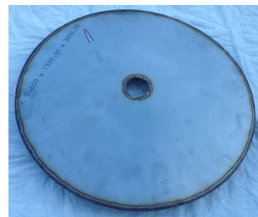
(c) Schweißverzug der doppellagigen kreisringförmigen „Die-Less-Hydroforming“-Platine entsprechend Abbildung 2 (a)
