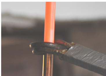
Bild: Konventionelle Induktionserwärmung eines Kupferrohrs mittels Ringinduktor
