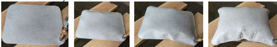
Abbildung 1: „Die-Less-Hydroforming“ eines kissenartigen Probekörpers aus 1.4301 (hier zu messtechnischen Zwecken mit einer speziellen Beschichtung versehen)
