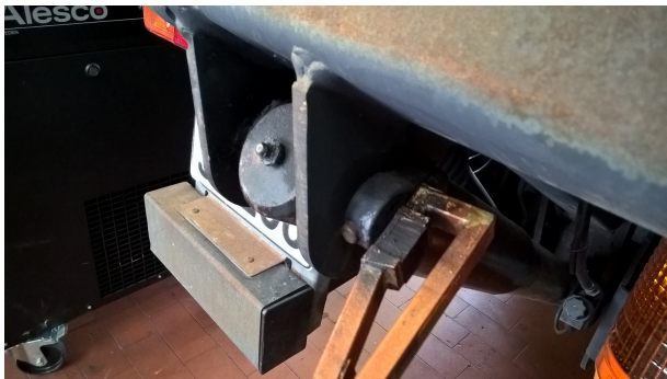
Bild: Scheinbar genau falsch herum, aber hoch wirksam - das Wärmen eines Bolzens zerdrückt den Rost!
