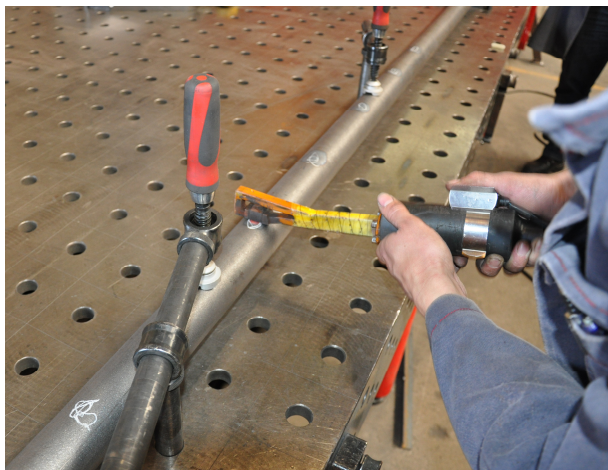
Bild: Dehnungsbehinderung durch Festspannen beim thermischen Richten eines Rohrquerschnitts
